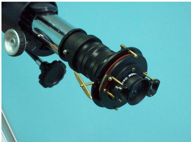
*Окулярный конец рефрактора «AstroMaster 90» с самодельным поворотным устройством и разделённым кругом для измерения позиционных углов двойных звёзд. Для повышения точности показания считываются с диаметрально противоположных сторон при помощи установленных над шкалой двух луп. Используемый окуляр не имеет подсветки нитей, применена подсветка поля зрения слабым красным светом через объектив трубы.*
