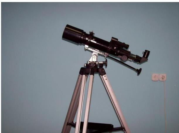
*Компактный рефрактор «Sky Watcher BK 705 AZ-3». Вместо штатной 45° диагональной призмы установлена 90° призма того же производителя, обладающая лучшим оптическим качеством. Длинная рукоятка ключа тонких движений по азимуту заменена на самодельную укороченную, чтобы избежать её зацепления за искатель.*
