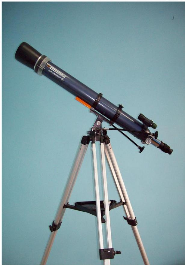
*Усовершенствованный рефрактор «AstroMaster 90» с самодельным устройством для юстировки объектива по оси и оптическим искателем из зрительной трубы «Tasco 8×21», установленный на азимутальной монтировке AZ-3 от Sky Watcher.*
